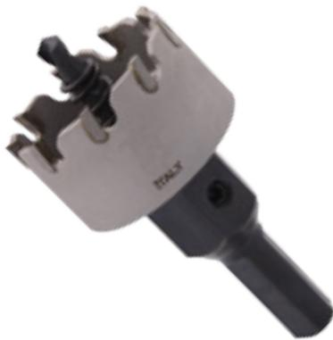
**Fresa a tazza T.C.T.** con denti in metallo duro, ideale per la foratura di precisioni di acciaio inox, acciai altamente legati e ghise dure; Ø anello da 15 a 200 mm; dente 2,5 mm; H utile di taglio 8 mm; H utile corpo 14 mm
