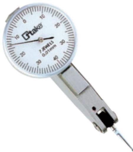
Tastatore a leva in acciaio cromato opaco, attacco a codolo a coda di rondine, campo di misura 0,8 mm., diametro 38 mm., risoluzione 0,01 mm.
