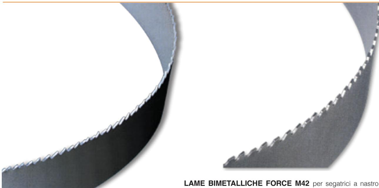
**LAME BIMETALLICHE FLEX M42** Lame bimetalliche FLEX M42 per segatrici a nastro, ideali per tagli di piccole o medie sezioni sia piene che interrotte di: acciai da costruzione, acciai medio legati, acciai al carbonio; acciai da bonifica, acciai da lavorazione, acciai inossidabili; materiali non ferrosi; ghise, rame, ottone; particolarmente indicate per seghetti a nastro manuali; 27x0,90 mm.
