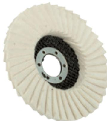
**Disco lamellare in feltro**, adatto ad operazioni di finitura lucida con pasta abrasiva; utilizzabile con smerigliatrici angolari; diametro 115mm
