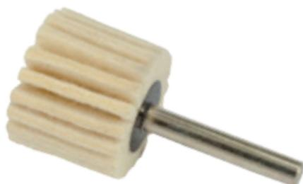
**Ruota lamellare in feltro con perno**, per la lucidatura con pasta abrasiva di piccole superfici ed interni di raccordi e tubi; utilizzabile con smerigliatrici diritte a bassi giri; gambo 6mm
