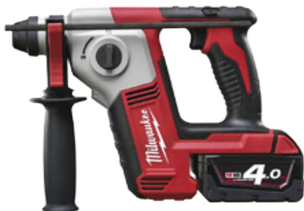
**Tassellatore compatto SDS M18 BH-402C**, 18V, potente motore a 4 poli, basse vibrazioni pari a 10 m/s<sup>2</sup>, ottimo rapporto peso potenza con potenza del colpo 1,2 J EPTA e peso 1,9kg, 6100 colpi/min, 2 modalità: rotopercolazione e sola rotazione, reversibile, ottimizzato per fori da 4 a 10mm (max 16mm), due batterie 4.0 Ah Li-Ion
