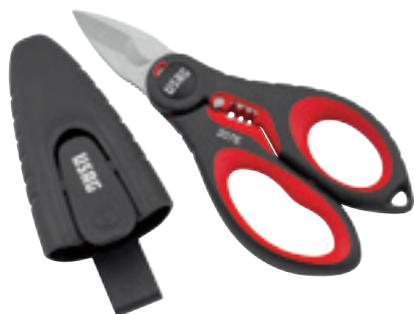
**Forbice professionale per elettricisti 207 E**, struttura integrale in acciaio inox (lama e manici interni), lama microdentata antiscivolo, tagliacavi su entrambe le lame (fino a 50 mm<sup>2</sup>), spellafili integrato (1,5-2,5-4 mm<sup>2</sup>), funzione crimpatura integrata, impugnature ergonomiche bimalteriali con asole sagomate, foro per aggancio, lunghezza tot. 155mm; supporto per cintura in materiale plastico con blocco di sicurezza incluso
