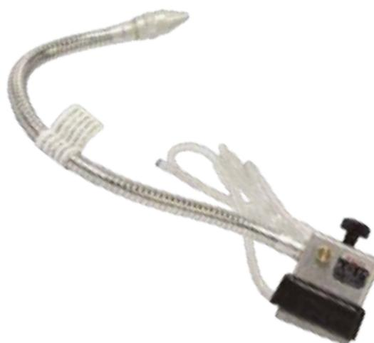
**NEBULIZZATORE PER LUBRIFICANTI**, particolarmente indicato per operazioni di taglio con lame a nastro, foratura, maschiatura, rettifica e taglio con disco ad alta velocità; dotato di una robusta base magnetica facilmente applicabile su qualsiasi macchina utensile e di un tubo di aspirazione del fluido da nebulizzare. Pressione di esercizio 50-100 psi, volume liquido in uscita 4 l/h, viscosità massima cSt a 40°C: 65-70. Si consiglia l'utilizzo con fluido refrigerante LUB MINIMAL Ttake.
