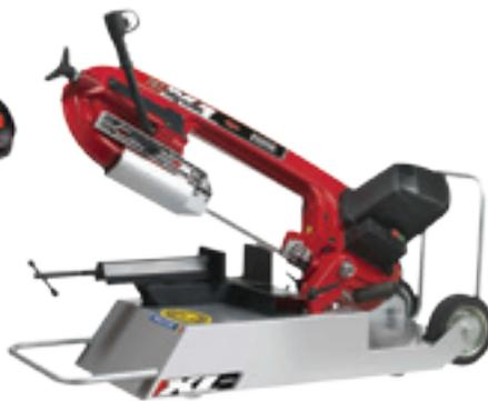
**Segatrice a nastro trasportabile 787XL ALL ROAD**, con base completa di due ruote, taglio max 213x150 mm., lama 2140x19x0.9 mm., braccio con sistema rototraslante, versatilità d'impiego, apertura morsa 213 mm., motore universale 1850W
