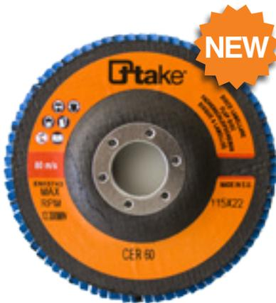
**Disco lamellare ceramico**, tela in polycotton, con supporto in fibra di vetro per elevate prestazioni; notevole capacità di asportazione e lunga durata; per utilizzo professionale; dimensioni 115x22,23 mm
