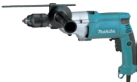
**Trapano a percussione a 2 velocità**, capacità foro: legno Ø 40 mm, metallo Ø 13 mm, cemento Ø 20 mm; potenza assorbita 720 W; velocità a vuoto I-0÷1200 g/min, II-0÷2900 g/min; colpi al minuto I-0÷24000, II-0÷58000; mandrino auto serrante Ø 13 mm; peso 2,5 kg.
