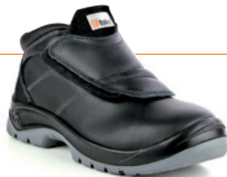
**RUTILIO:** S3 SRC HRO, tomaia in pelle traspirante idrorepellente, fodera in tessuto PLASMAFEEL, soletta termoformata Fusstatic estraibile, suola in gomma, puntale in composito 200J, lamina in composito Perforazione Zero, misure da 38 a 48, specifica per l'industria pesante (acciaierie, saldatura, ecc.)
