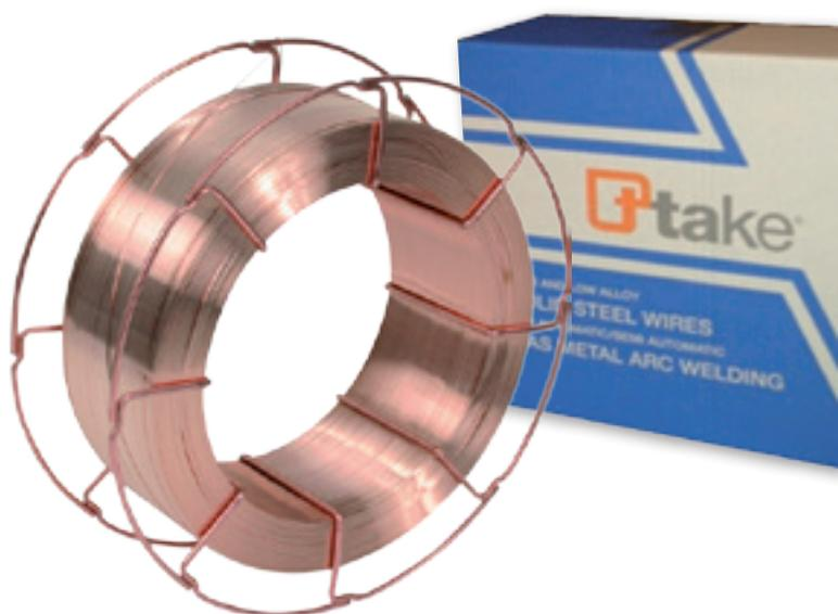
**Filo pieno ramato** per la saldatura sotto protezione di gas CO<sub>2</sub> o miscela di Ar/CO<sub>2</sub> di acciai al carbonio, acciai al manganese e similari, anche a grana fine. Caratterizzato da elevato rendimento, buona operatività anche in posizione, bassa emissione di spruzzi, ridotta quantità di silicati ed eccellente estetica del cordone.
