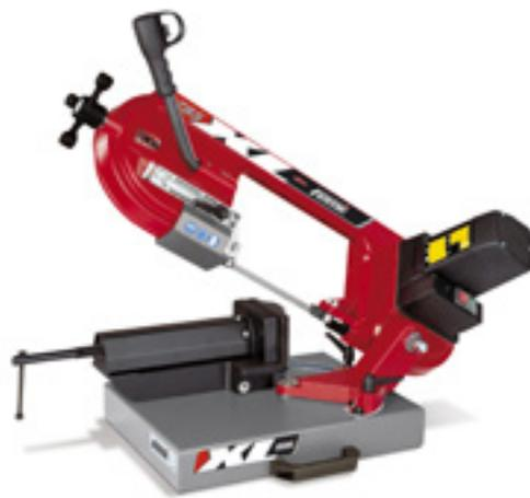
**Segatrice a nastro trasportabile 784 XL**, con regolazione elettronica della velocità; impugnatura soft-grip; tendilama frizionato; taglio max a 0° Ø 120 mm - 120x115 mm; peso kg 17; lama mm 1440x13x0.65; potente motore 1200W
