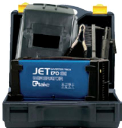
**Saldatrice ad inverter Jet 170 GE:** 1 pH x 230 V, per saldatura MMA, fornita con valigia e kit saldatura composto da maschera a mano, martospazzola, cavo con pinza di massa e cavo con pinza portaelettrodo; adatta per inox, rame, nichel, ecc.; dotata di protezione termostatica; adatta all'impiego con motogeneratori (tolleranza tensione ingresso +/-30%)
