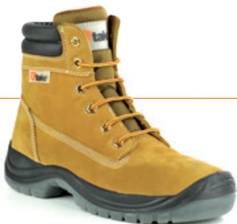
**DIORITE:** S3 SRC, tomaia in pelle Nubuk traspirante idrorepellente, fodera in tessuto PLASMAFEEL, soletta termoformata Fusstatic estraibile, suola in poliuretano bidensità, puntale in composito 200J, lamina in composito Perforazione Zero, misure da 39 a 47, specifica per l'edilizia
