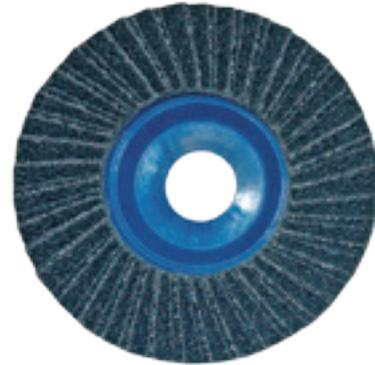
**Disco lamellare Ttay**, a singola lamella, costruito con tela abrasiva allo zirconio di nuova generazione e supporto in nylon; per impiego universale. Dimensioni 115x22 mm.; confezioni da 20 pz.
