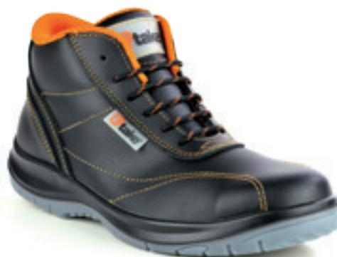
**ARDESIA:** S3 SRC, tomaia in pelle traspirante idrorepellente, fodera in tessuto PLASMAFEEL, soletta termoformata Fusstatic estraibile, suola in poliuretano bidensità, puntale in composito 200J, lamina in composito Perforazione Zero, misure da 36 a 48 e da 39 a 48 per la versione MID
