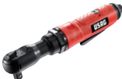
**Cricchetto 913 PC2 1/2"**, modello reversibile ultracompatto con scarico dell'aria posteriore, corpo esterno in materiale composito ad alta resistenza e carter anteriore in acciaio; capacità M10; coppia massima 108Nm; 280 giri/min; attacco filettato 1/4"; pressione di esercizio 6,2bar
