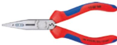
**Pinza combinata per elettricisti e cablatori**, testa pulita, manici rivestiti in resina sintetica; per serrare e curvare fili e tagliare fili a bassa, media e alta resistenza, taglienti di precisione 60 HRC, valori di spelatura 0,5-0,75/1,5/2,5 mm<sup>2</sup>, lunghezza 160 mm.
