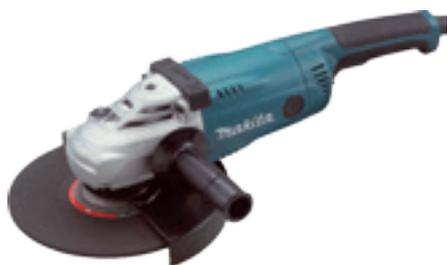
**Smerigliatrice angolare 230 mm**. diametro disco 230 mm; potenza assorbita 2200 W; velocità a vuoto 6600 g/min; peso (normativa EPTA) 5,8 kg
