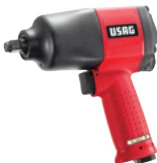
**Avvitatore 928 PC1 1/2"**, modello reversibile con meccanismo a doppio martello, scarico dell'aria convogliato attraverso l'impugnatura, coppia di lavoro regolabile, carcassa ultraleggera in materiale composito ad alta resistenza e carter anteriore in acciaio; capacità M16; coppia massima 1080Nm; 8000 giri/min; attacco filettato 1/4"; pressione di esercizio 6,2bar
