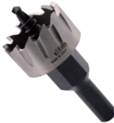
**Fresa a tazza HSS con scarico laterale** adatta per ferro, acciaio, ottone, ghisa, bronzo; migliore evacuazione del truciolo e refrigerazione del dente, Ø anello da 8 a 150 mm; durezza dente 64/65 HRC; H utile di taglio 8 mm; H utile corpo 12 mm.
