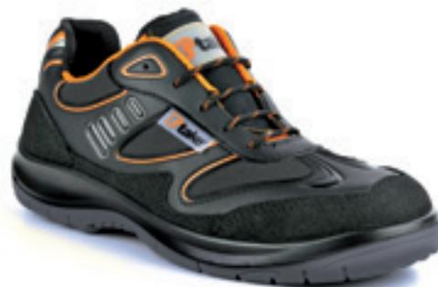
**CRIOLITE:** S3 SRC, tomaia in microfibra-pelle-tessuto idrorepellente e traspirante, fodera in tessuto PLASMAFEEL, soletta termoformata Fusstatic estraibile, suola in poliuretano bidensità, puntale in composito 200J, lamina in composito Perforazione Zero, misure da 38 a 48
