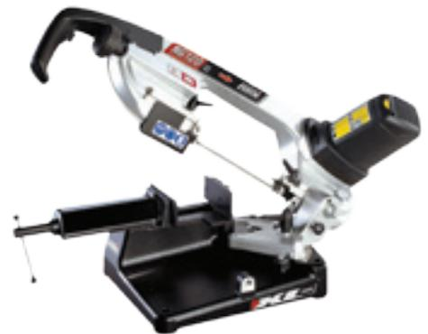
**Segatrice a nastro trasportabile NG120XL**, motore 1300W con regolatore elettronico digitale di velocità, tendilama frizionato (brevetto esclusivo), taglio fino a 60° SX con blocco rapido 45° e 60°, doppio guidalama scorrevole anteriore e posteriore, taglio max a 0° Ø 120 mm., peso Kg 18, lama 1440x13x0.65 mm., NG System (rotazione contraria della lama) per una riduzione dei tempi di taglio fino al 60%
