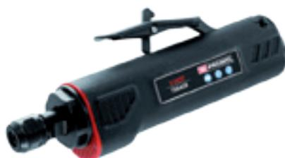
**Smerigliatrice diritta V.445F**, a pinza Ø 6mm, con scarico dell'aria anteriore; tubo consigliato Ø interno 10mm; velocità di rotazione 20.000 giri/min; attacco filettato 1/4"; pressione di utilizzo 6,2bar; potenza 0,75kW
