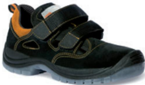
**CADMIO:** S1P SRC, tomaia in pelle scamosciata traspirante con inserti in tessuto, fodera in tessuto PLASMAFEEL, soletta termoformata Fusstatic estraibile, suola in poliuretano bidensità, puntale in composito 200J, lamina in composito Perforazione Zero, misure da 38 a 48
