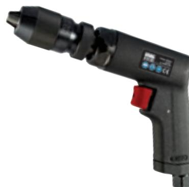
**Trapano 916 B2**, modello non reversibile con impugnatura a pistola, mandrino autoserrante, scarico dell'aria convogliato attraverso l'impugnatura e pulsante il controllo della velocità; capacità 10Nm; 2800 giri/min; attacco filettato 1/4"; diametro interno minimo tubo aria 10mm; pressione di esercizio 6,2bar
