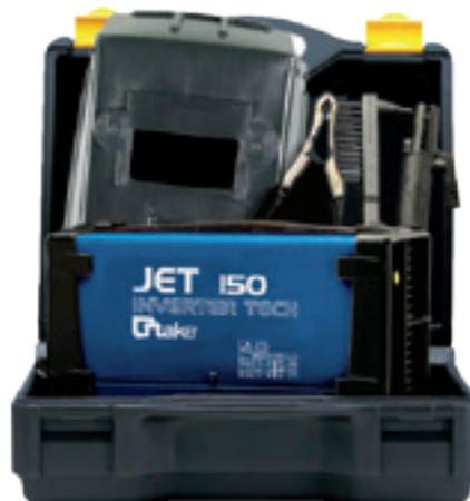
**Saldatrice ad inverter Jet 150:** 1 pH x 230 V, per saldatura TIG e MMA, completa di kit saldatura con maschera a mano, martospazzola, cavo con pinza di massa, cavo con pinza portaelettrodo e torcia; adatta per inox, rame e nichel, ecc.; dotata di protezione termostatica; fornita in valigia; adatta all'impiego con motogeneratori (tolleranza tensione ingresso +/-15%)
