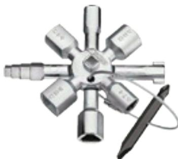
**Chiavi universali per quadri e armadi elettrici TwinKey®** per tutti i sistemi di chiusura più comuni, corpo chiave nichelato; versione a 8 bracci: 2 chiavi a croce unite tramite calamite per un minimo ingombro, con inserto per viti con intaglio 1x7 mm e a croce PH 2, chiavi e inserto per viti uniti da robusto filo metallico in acciaio inox
