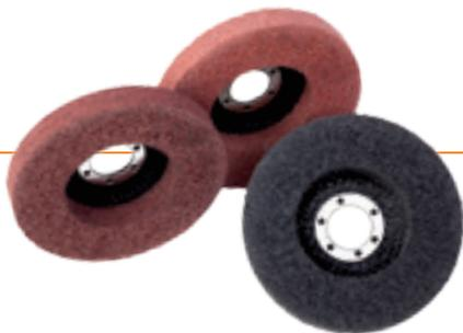
**Disco compatto ad alta densità**, composto da una combinazione di tessuti abrasivi ad altissima densità, con supporto in fibra di vetro; particolarmente indicato per finiture su acciaio inox e come finitura dopo l'impiego di dischi lamellari o dischi fibrati; utilizzabile anche per la preparazione di superfici per trattamenti galvanici o di verniciatura; durezza: soft, medium, hard
