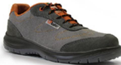
**OPALE:** S3 SRC, tomaia in pelle scamosciata traspirante idrorepellente, fodera in tessuto PLASMAFEEL, soletta termoformata Fusstatic estraibile, suola in poliuretano bidensità, puntale in composito 200J, lamina in composito Perforazione Zero, misure da 36 a 48 e da 39 a 48 per la versione MID
